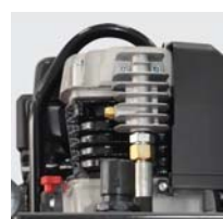
Кожух для защиты подвижных частей компрессора
